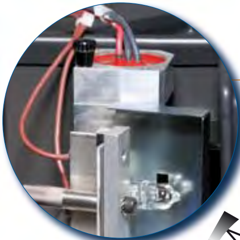
Compartimiento de lámparas, aislado termicamente de la banca óptica
