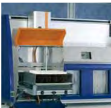
Ofrecemos dos charolas distintas para las muestras: a) una charola con 56 posiciones para botellas de 20 ml. Usado para Micro-viscosimetría
