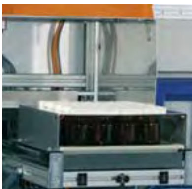
El ascensor eléctrico asegura que las muestras se coloquen correctamente en la charola a una altura conveniente y de fácil supervisión.
